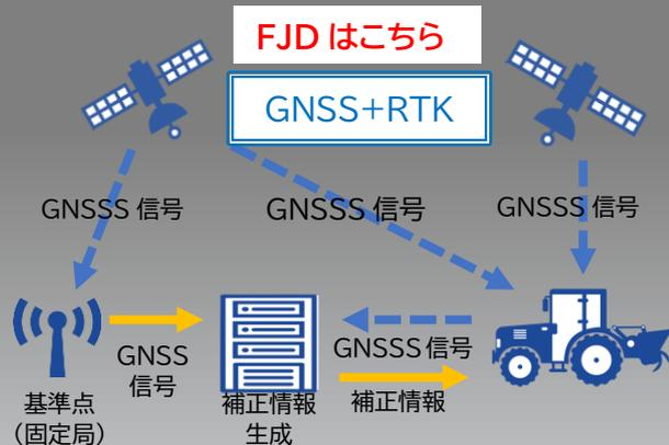
GNSS の他にネットワークを介して補正情報を受信している為、月々のランニングコストは発生します。リアルタイムに測位しているので±2.5cm といった高精度な作業を可能としています。(測量、自動操舵、自動ドローン)
