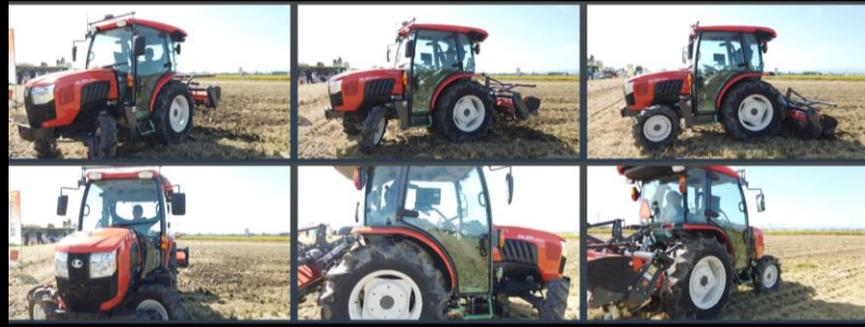
自動隣接旋回モードによる耕うん作業
